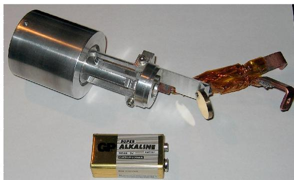
Рис. 3.28: Фотография конфигурации четырех проводников с током, образующих квадрупольное поле внутри 2D МОЛ.
