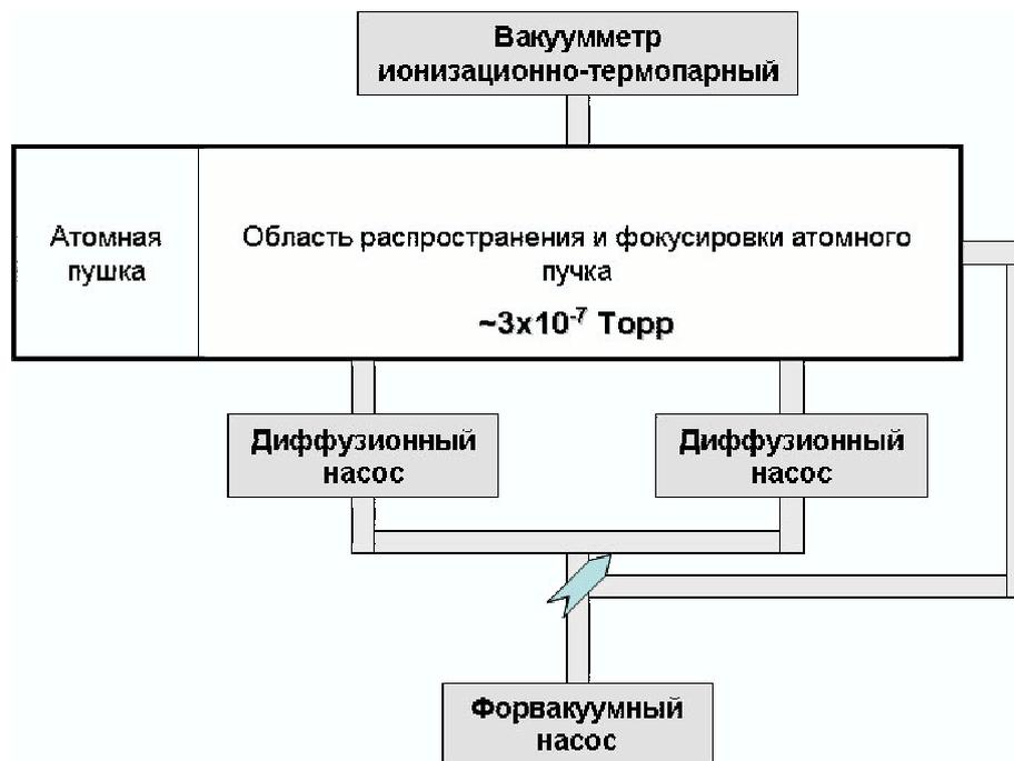
Рис. 3.14: Принципиальная схема вакуумной камеры.
