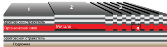
Рис. 1.6: Схема образца с микрорезонаторным слоем. Область 1 не содержит металла. Область 2 содержит слой серебра толщиной 40 нм. В области 3 все слои периодически структурированы (период полос 7.4 или 11.1 мкм) [37].
