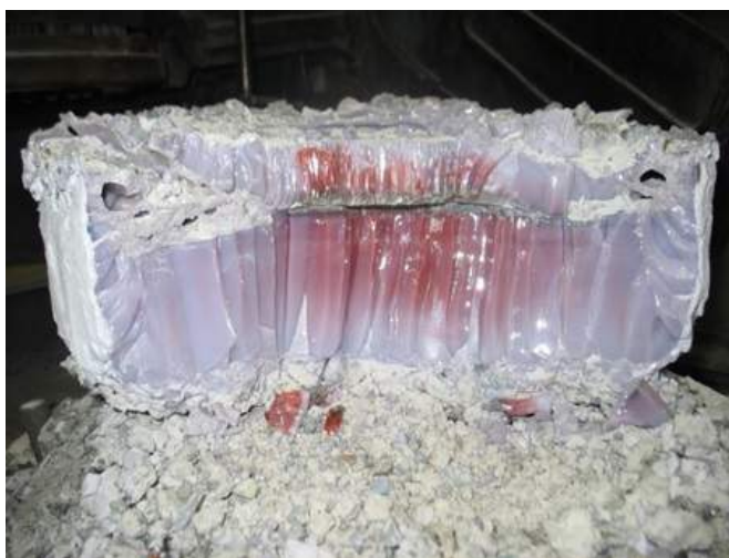
Рис. 2.19: Були монокристаллов после роста с использованием указанной установки высокочастотного нагрева в холодном тигле
