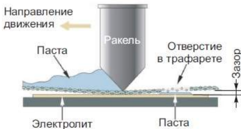
Рис. 2.40: Принцип работы метода трафаретной печати
