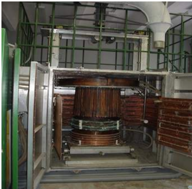
Рис. 2.18: Установка для роста кристаллов методом высокочастотного нагрева в холодном тигле
