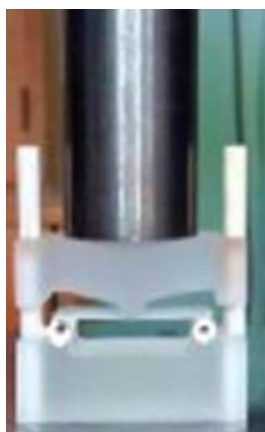
Рис. 2.1: Образец мембраны анионного проводника в оснастке из монокристаллического сапфира для исследований в установке Instron
