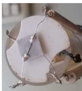
Рис. 2.2: Образец с платиновыми электродами и платиновыми токоподводящими проводами перед высокотемпературными измерениями
