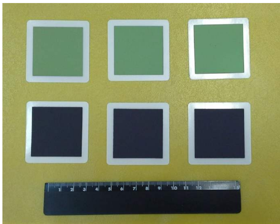
Рис. 4.30: Фотографии мембранно-электродных блоков ТОТЭ, изготовленных методом совместного спекания электродов
