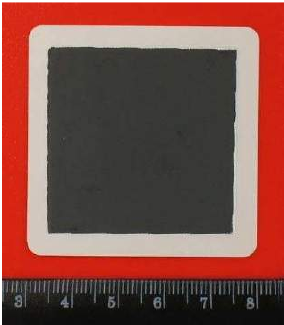
Рис. 4.6: Фотография мембраны твердого электролита производства компании Fuel Cell Materials с нанесенным и спеченным катодным слоем
