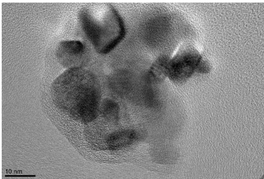
Рис. 4.13: Изображение частиц наноразмерного оксида никеля, полученное методом ПЭМ ВР
