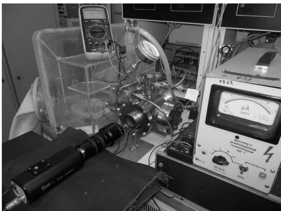
*Рисунок 3.1. Внешний вид установки окисления в ТПП.*
