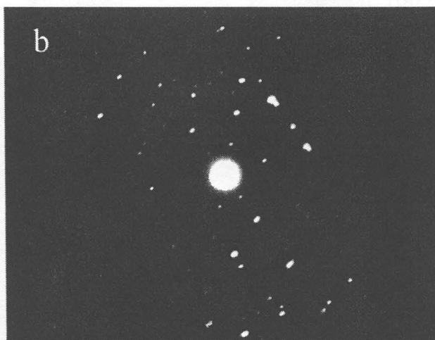
Рис. 6.10. Микроструктура глубинных слоев отожженного образца сплава Pd_{40}Ni_{40}P_{20} ((a) светлопольное изображение, (b) – микродифракция)
