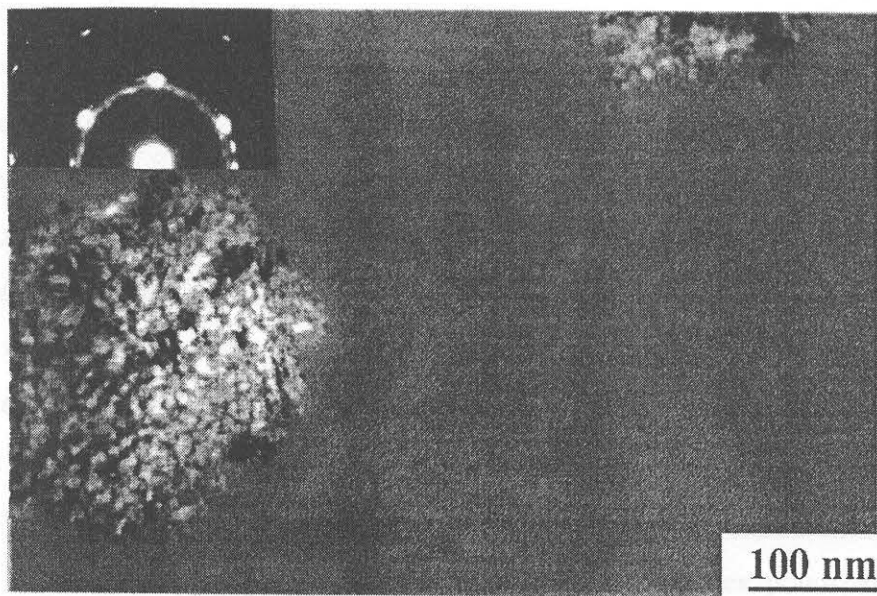
Рис.4.6. Микроструктура образца сплава Ni_{70}Mo_{10}P_{20} после отжига при 673 К в течение 1 часа
