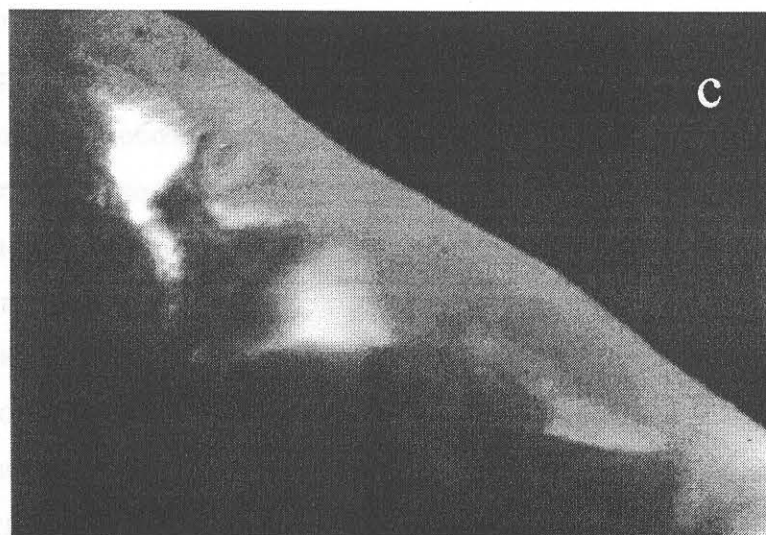
Рис.6.18. Сетлопольное (a), микродифракция (b) и темнопольное (c) в отмеченном стрелкой рефлексе изображения структуры приповерхностного слоя отожженного образца Fe_{83}B_{10}P_7
