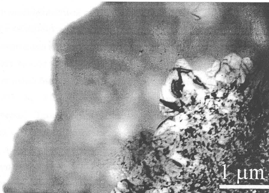
Рис.6.14. Микроструктура частично закристаллизованного "in-situ" предварительно отожженного образца \text{Fe}_{83}\text{B}_{10}\text{P}_7
