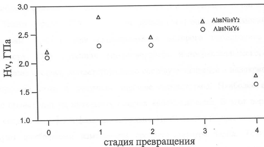
Рис. 7.35. Зависимость микротвердости сплавов системы Al-Ni-Y от термообработки (1-температура центра 1 пика на кривой ДСК при скорости нагрева 20 К/мин, 2 – температура окончания 1 пика, 3 температура центра второго пика, 4 – температура окончания второго пика)
