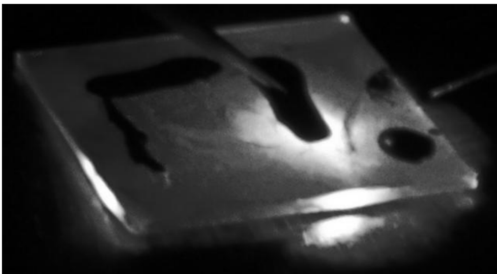
Рисунок 2. Фотография электролюминесценции образца светодиодной гетероструктуры GaPNAs/GaP с прозрачным электродом, сформированным из графена.
