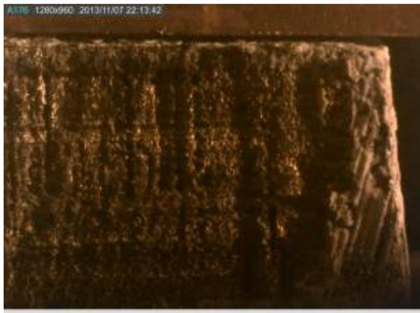
Рис. 3.9. Поверхность бария после очистки. Справа на фотографии видна неочищенная область
