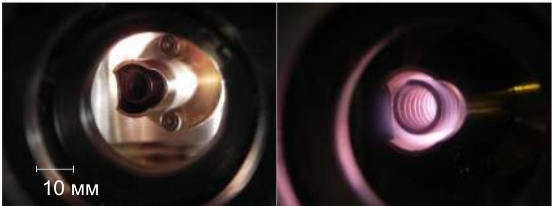
Рис. 3.6. Фотографии спирального резонатора. Слева фотография резонатора на которой видна срезанная нижняя часть, справа изображено свечение модулированного высокочастотного разряда в гелиевой атмосфере. Фотографии сделаны с помощью микроскопа Dinolite через боковое окно криостата
