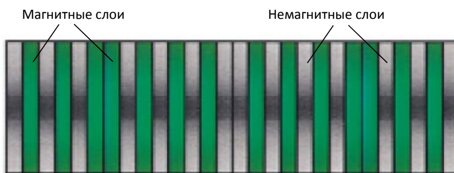
Рис. 1.6: Схема одномерного МФК, состоящего из чередующихся магнитных и немагнитных слоев с дефектами чередования [48].
