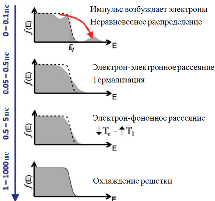
Рис. 1.12: Эволюция функции распределения электронов в металле при воздействии на него импульса лазерного излучения. Изменения в распределении электронов приводят к изменениям диэлектрической проницаемости металла [150].
