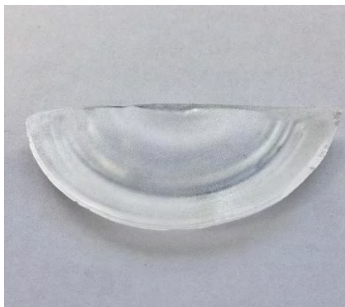
Рис. 5.44. Образец кристалла парателлурита (нижняя часть були). Видна неравномерность ростового фронта кристалла, в результате чего нижней край були сильно искажен.
