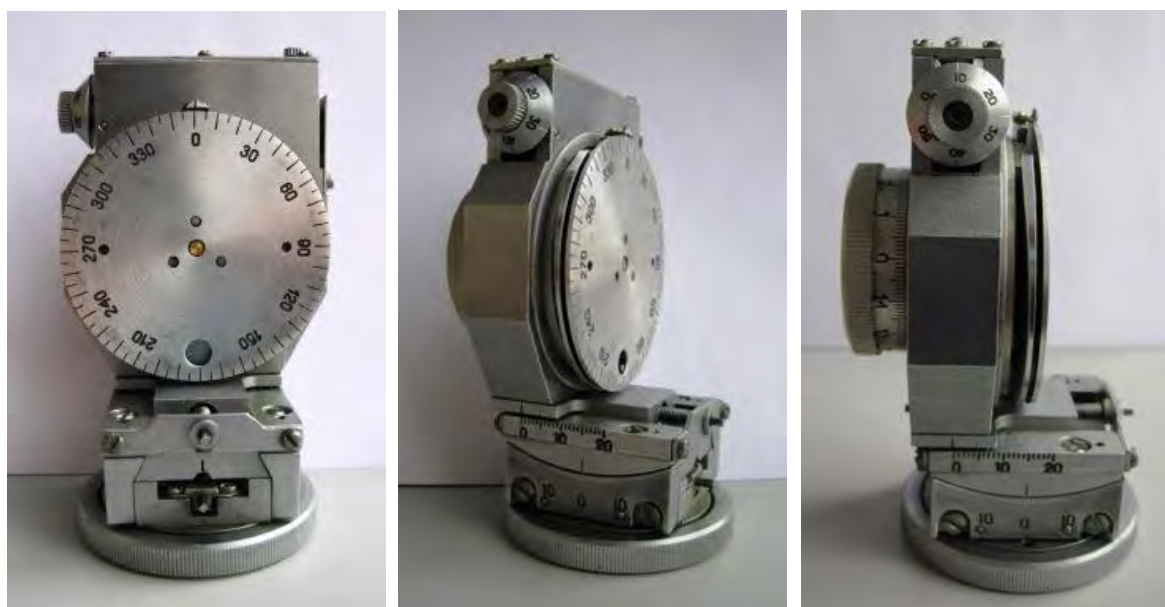
Рис. 5.18 Специальный кристаллодержатель, обеспечивающий возможность юстировки исследуемого образца (кристаллической пластины), позволяющей реализовать азимутальное вращение пластины вокруг вектора обратной решетки симметричного рефлекса. Кристаллодержатель обеспечивает наклон и азимутальное вращение подложки для крепления пластины независимо от наклона и азимутального вращения массивной головной части кристаллодержателя.
