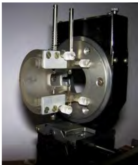
Рис. 2.27. Кристаллодержатель для рентгеноакустического резонатора, разработанный и изготовленный для проведения рентгенодифракционных экспериментов геометрии Брэгга.
