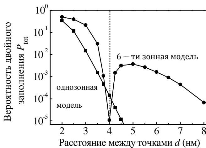
Рис. 4.19. Вероятность локализации двух дырок на одной квантовой точке, P_{tot} , рассчитанная в рамках однозонной и многозонной модели для основного состояния синглета ^1\Sigma_g^{(a)} для квантовых точек размером l = 15 нм. Здесь P_{tot} = P_{BV} + P_{TV} , где P_{BV} ( P_{TV} ) вероятность локализации двух дырок на нижней (верхней) квантовой точке. Пунктирной линией выделено расстояние, при котором происходит смена симметрии основного состояния дырки.
