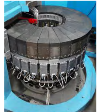
Рисунок 21 – Схема кольцевого дифрактометра ДИСК (а): 1 – пучок нейтронов; 2,4,6 – система коллиматоров; 3 – монохроматор; 5 – мониторная камера; 7 – детекторная система. Внешний вид дифрактометра ДИСК (б)
