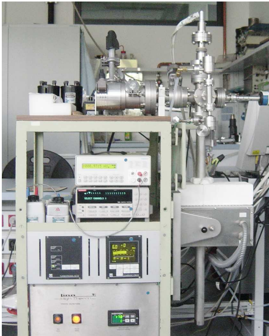
Рис. 1.15: Экспериментальная установка для измерения термоэдс и сопротивления при температурах от 80 К до 1300 К.
