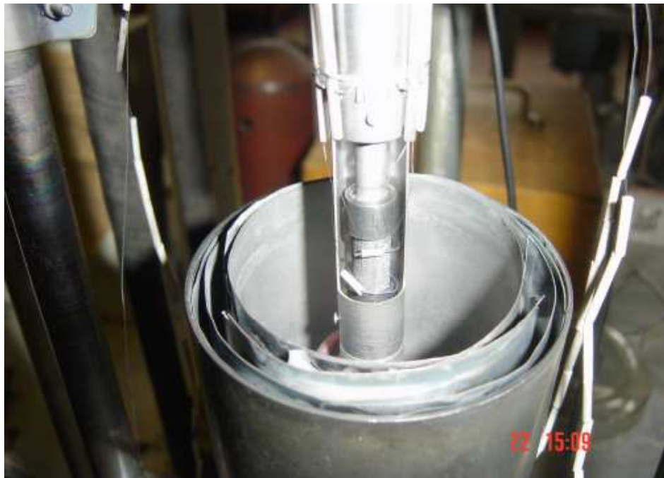
Рис. 1.23: Держатель образцов в вакуумной камере. Держатель помещается в систему тепловых экранов. В центре этой системы находится нагреватель в виде свободно стоящей вольфрамовой спирали.
