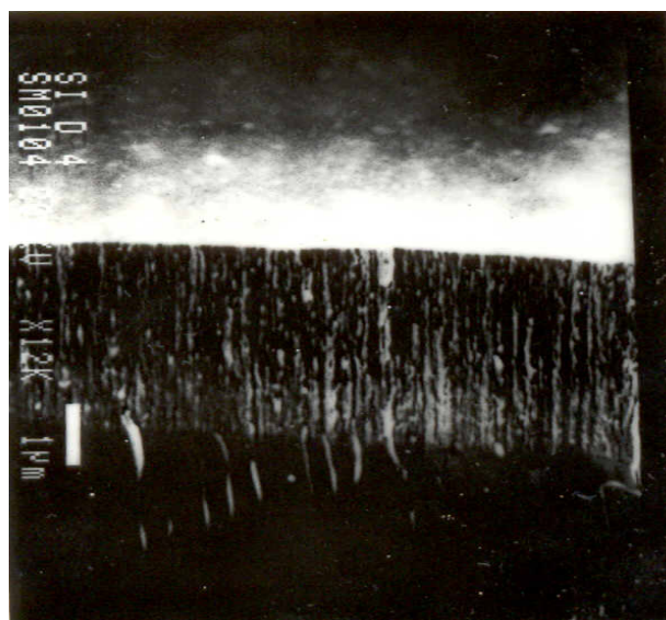
Рис.3.2.1. Вид бокового скола монокристалла КДБ(111)0.005 с ПК, полученный с помощью растрового электронного микроскопа.
