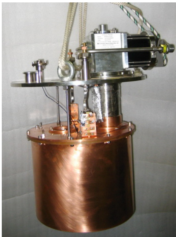
Рис. П.9. Криомагнит с установленным радиационным экраном.
