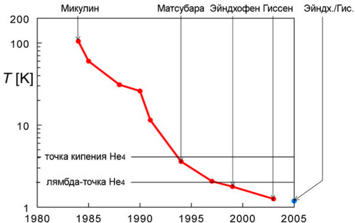
Рис. 1.14. Прогресс в получении низких температур с помощью криорефрижераторов.
