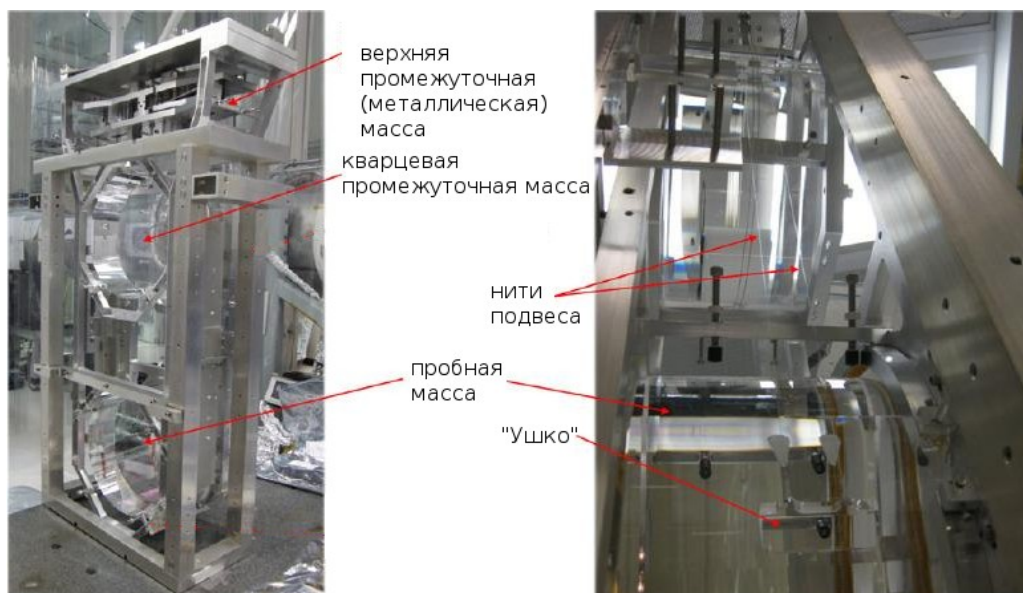
Рис. 1.3. Подвес пробной массы Advanced LIGO [30].
