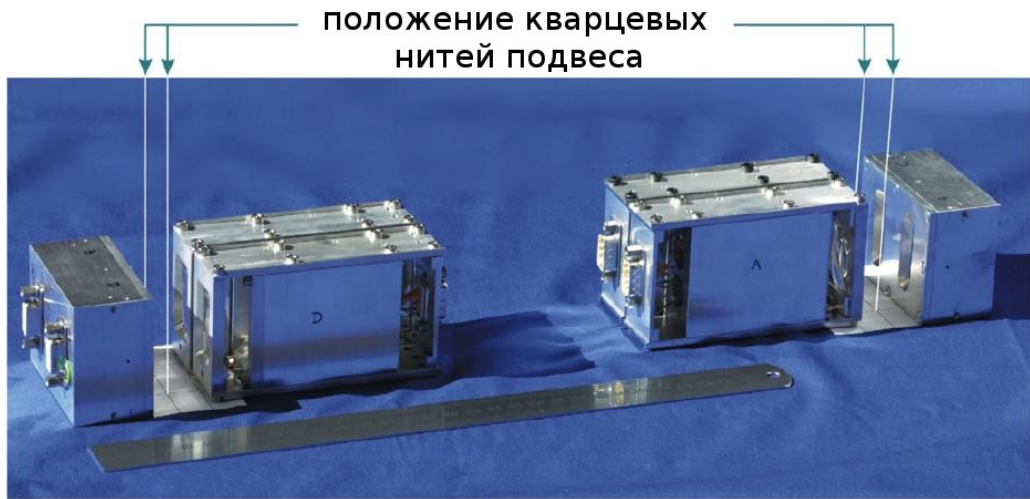
Рис. 1.4. Блок детектирования струнных мод колебаний подвесов пробных масс [32].
