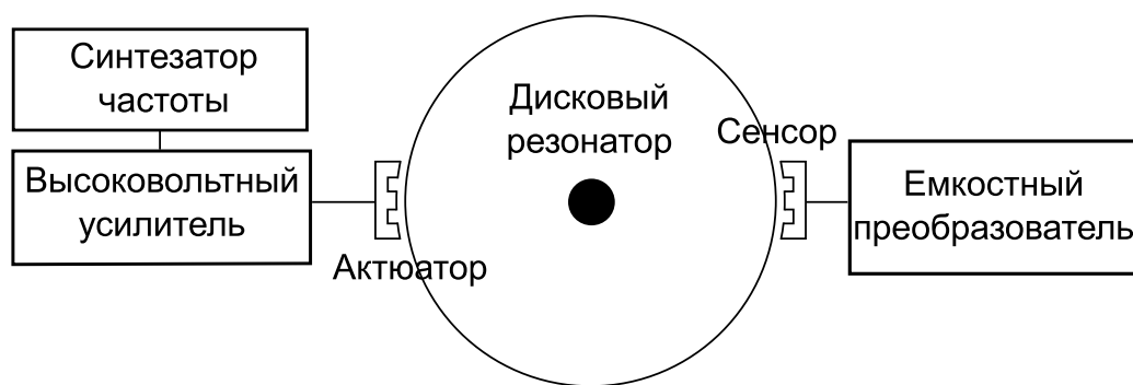
Рис. 3.14. Схема экспериментальной установки. Переменное напряжение требуемой частоты генерируется синтезатором частоты и подается через высоковольтный усилитель на гребенчатый электрод актюатора. Возбужденные в дисковом резонаторе колебания регистрируются посредством измерения изменения электрической емкости между дисковым резонатором и электродом сенсора с использованием емкостного преобразователя.
