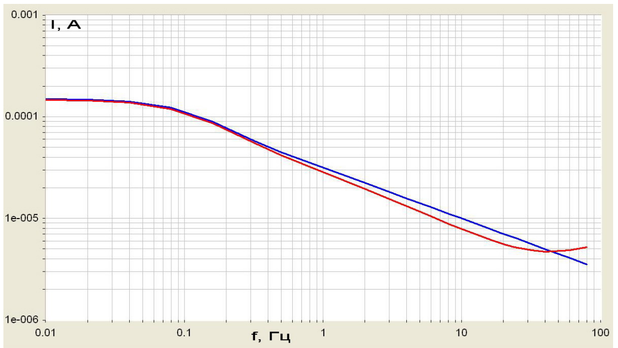
Рис. 2.9. АЧХ анодного (красная кривая) и катодного (синяя кривая) токов пространственно ограниченной ЭЯ.
