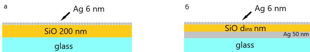
Рисунок 28. Схема расположения слоёв на исследуемых подложках. а – тестовая структура с фиксированной толщиной SiO, б – структура с дополнительным слоем толстого (50 нм) серебра и переменной ( $d_{ins} = 30, 50, 75, 100$  и  $150$  нм) толщиной отдаляющего слоя монооксида кремния. Рисунок из работы [33].
