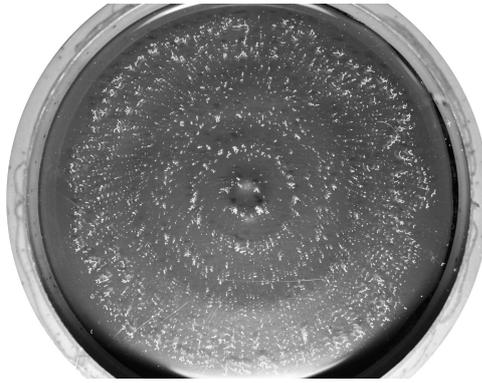
Рисунок 3.1 — Фотография поверхности воды при колебаниях цилиндрического сосуда на частоте 25 Гц с амплитудой меньшей критической для возбуждения параметрического резонанса
