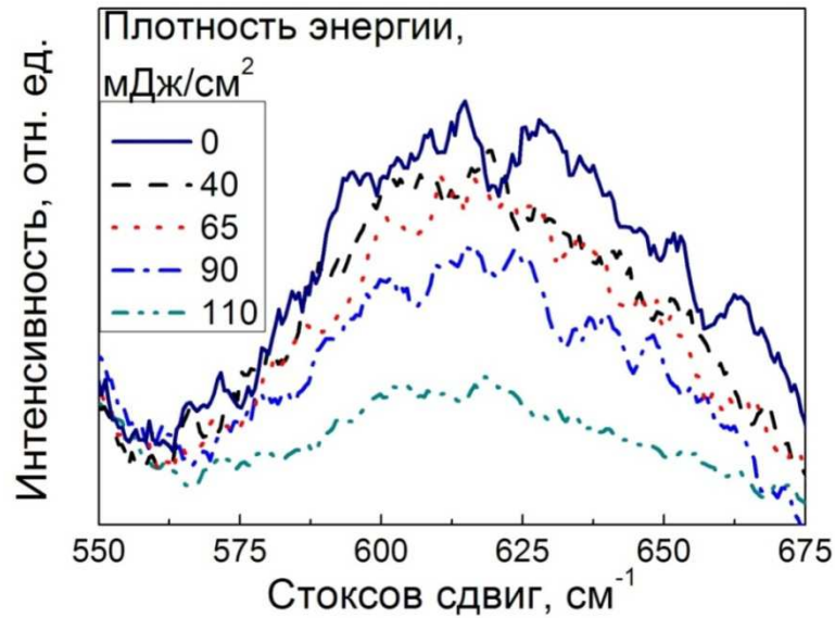
Рис. 1.18. Часть спектра рамановского рассеяния света, соответствующая Si-H колебательным модам, для пленок a-Si:H, подвергнутых ФЛЮ. Числа на рисунке соответствуют значениям плотности энергии лазерных импульсов при облучении a-Si:H.
