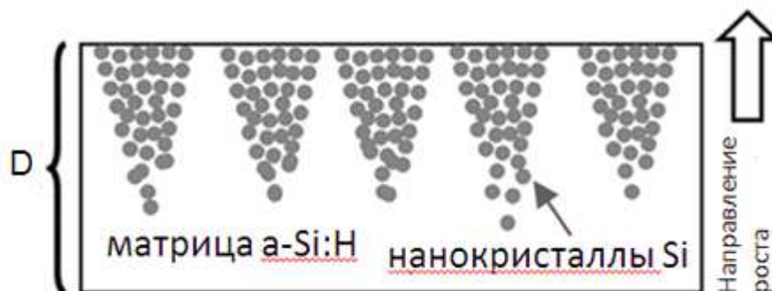
Рис. 1.3. Схематичное изображение изменения с толщиной (D) структуры пленки гидрогенизированного кремния, полученного методом плазмохимического осаждения из газовой фазы смеси газов моносилана и водорода [49]. По мере увеличения толщины пленки происходит переход структуры от аморфной к нанокристаллической.
