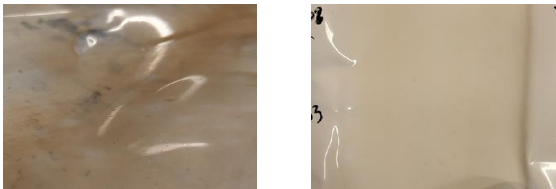
Рисунок 33 — Образец мембраны, полученной полуавтоматическим методом после отжига (слева) и после протонирования и очистки в \text{H}_2\text{O}_2 (справа)
