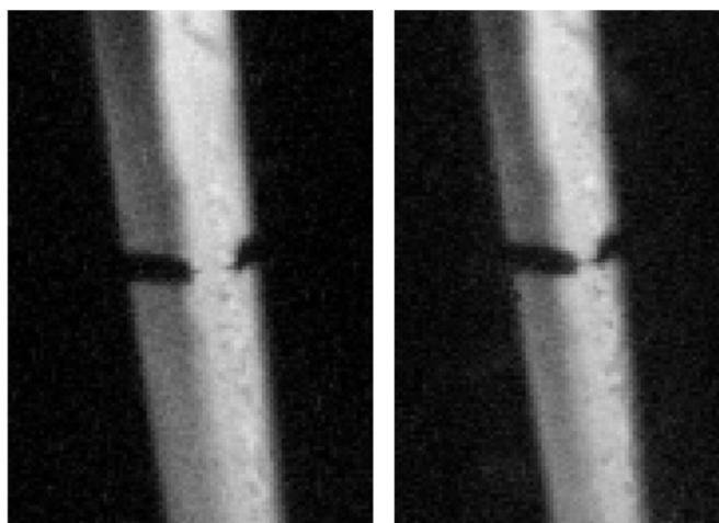
Рисунок 2 [29]. Подвод зонда к образцу в сверхтекучем гелии: слева – конец иглы зонда на расстоянии ~10 мкм от поверхности, справа – момент касания зондом поверхности.
