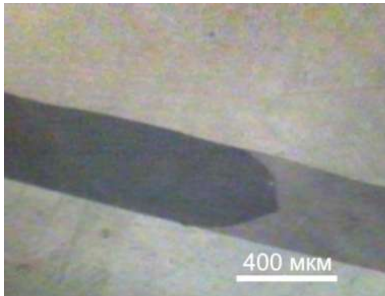
Рис. 2.2. Вид мигрирующей ГЗ с фасеткой (граница наклона [10\bar{1}0] в цинке с углом разориентации 30^\circ ).
