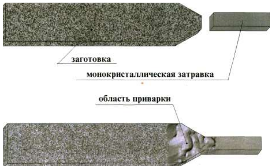
Рис. 2.8. Схема приварки монокристаллической затравки к заготовке.
