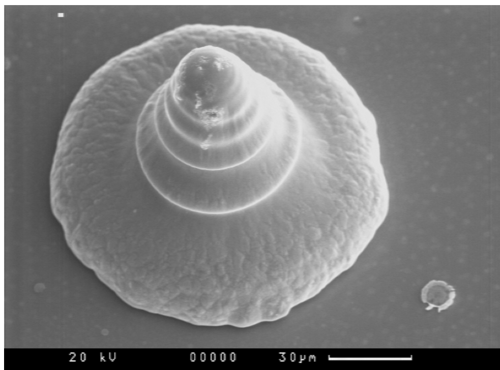
Рис.1.12: Морфология поверхности подложки после нанесения частиц в разряде с напряжением 15 кВ
