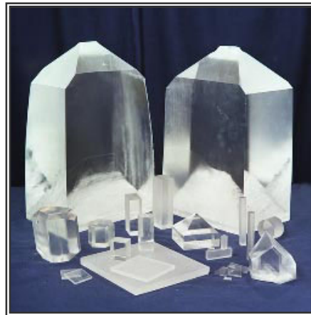
Рис. 2.18. Кристаллы группы KDP и полученные из них различные элементы для технических применений.
