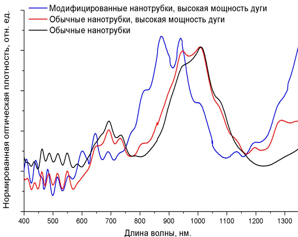
Рисунок 24. Спектры поглощения модифицированных нанотрубок при максимальной мощности дуги (синий), немодифицированных при максимальной мощности дуги (красный), немодифицированных при обычной мощности дуги (чёрный). Гелиевая атмосфера.
