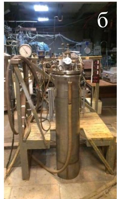
Рис. 2.2.3 а) Схематическое изображение криостата со сверхпроводящим соленоидом: 1 – токовводы питания соленоида, 2 – отверстие для трубки с датчиком измерителя уровня жидкого гелия, 3 – отверстия для заливки жидкого азота в азотную банку, 4 – горловина криостата, 5 – сверхпроводящий соленоид. б) Фотография криостата.
