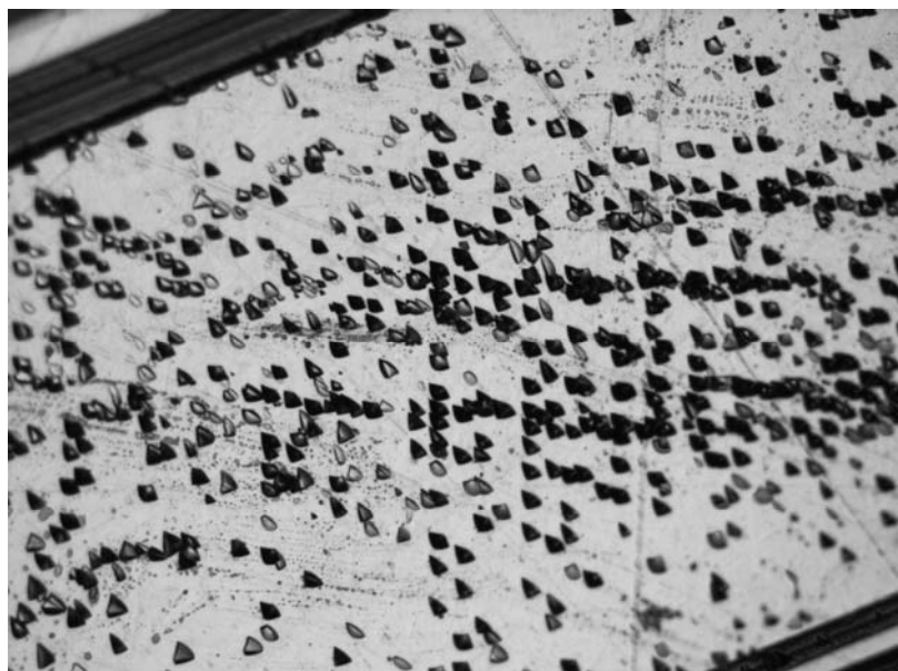
Рис 4.6. Микрофотография поверхности образца моноизотопного кремния, выращенного методом бестигельной зонной плавки без затравки после избирательного травления.
