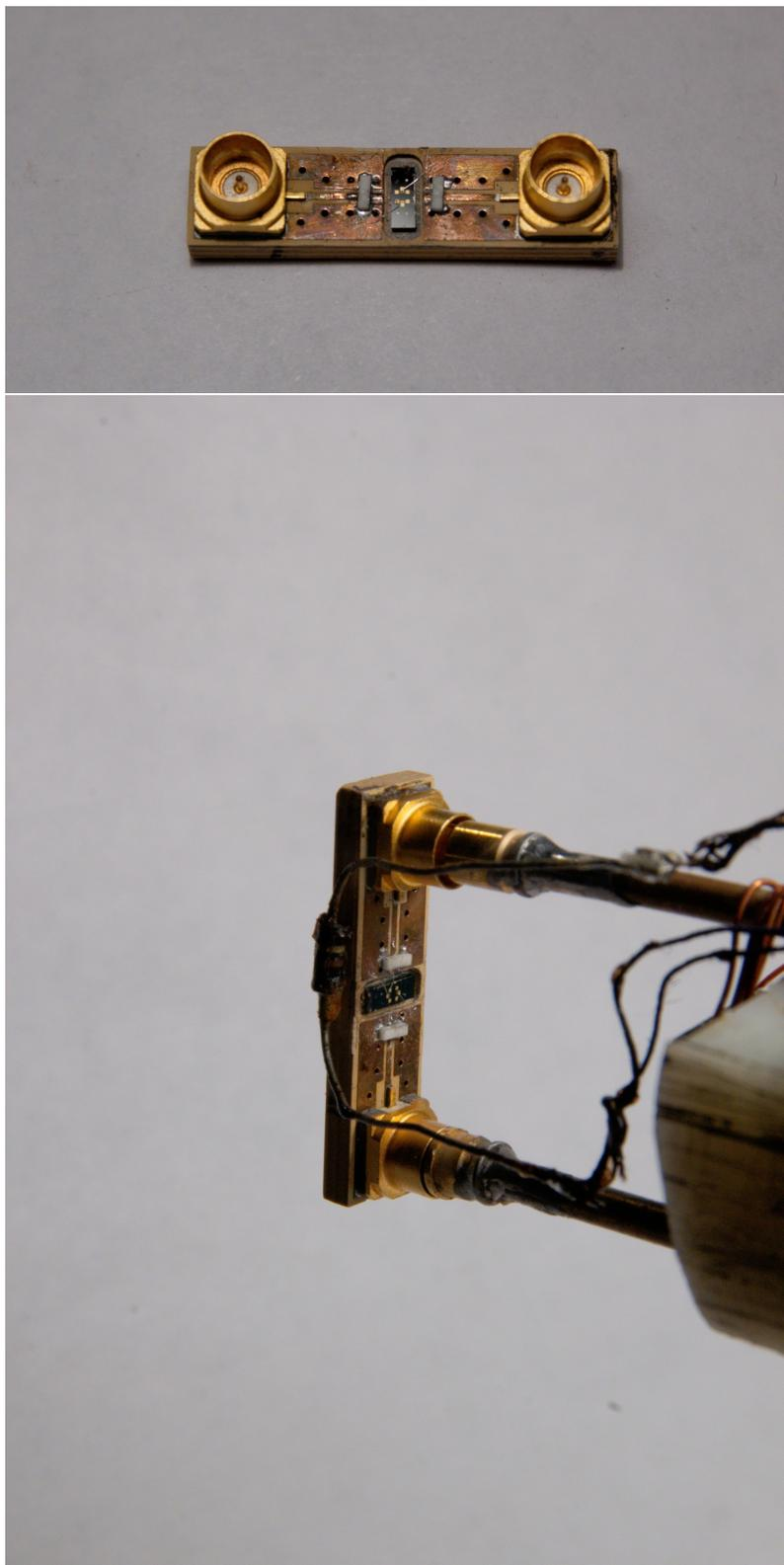
Рисунок 2.4: Держатель с замонтированным на нём образцом, а также держатель, закреплённый на конце низкотемпературной вставки.
