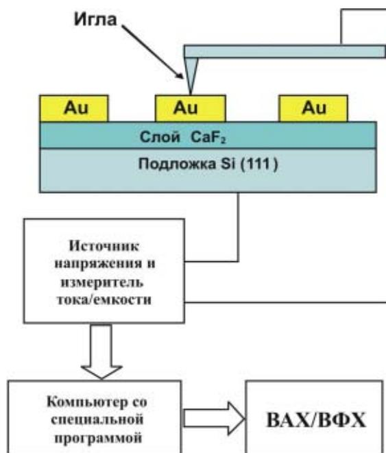
**Рис. 2.9:** Схема измерений ВАХ/ВФХ.
