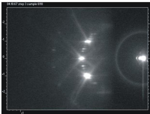
**Рис. 2.2:** Дифракционная картина от поверхности Si(111) с реконструкцией 7×7.
