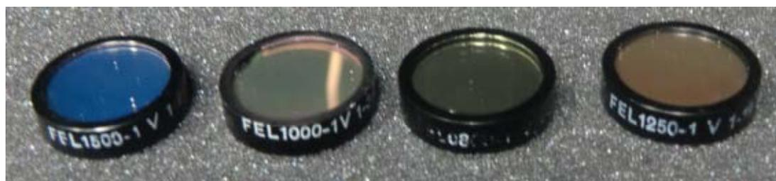
**Рис. 2.18:** Длинноволновые фильтры, использованные при оптических измерениях.
