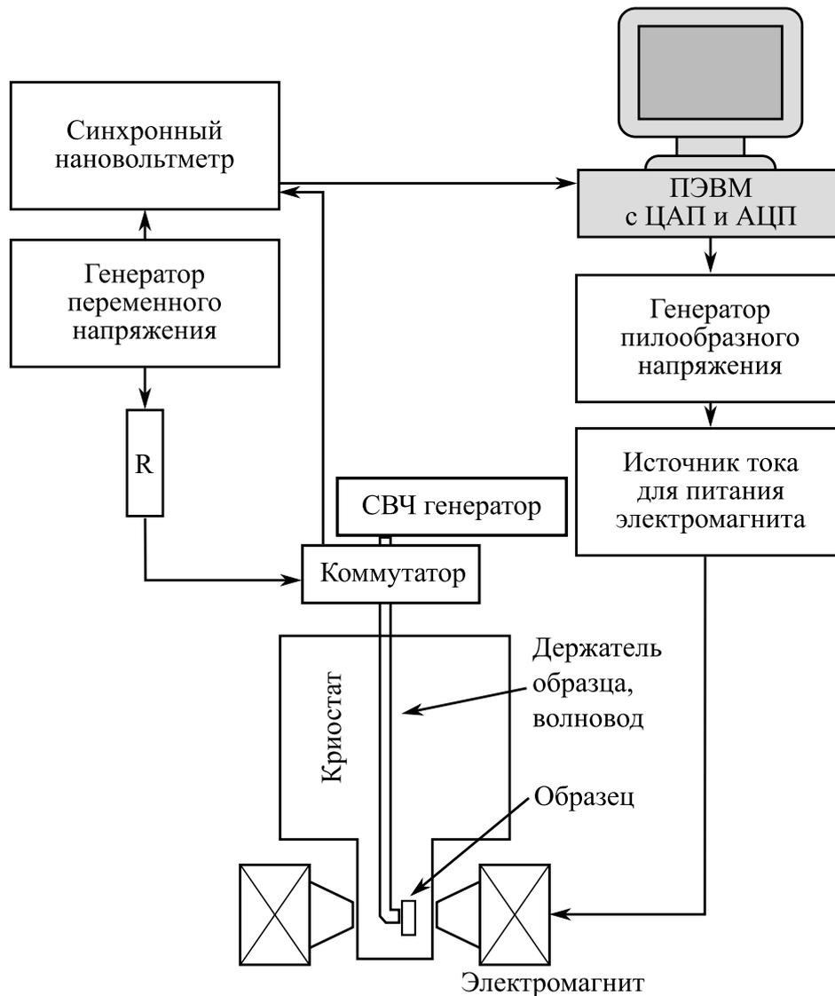
**Рис. 20.** Схема установки магнитотранспортных измерений в криостате.
