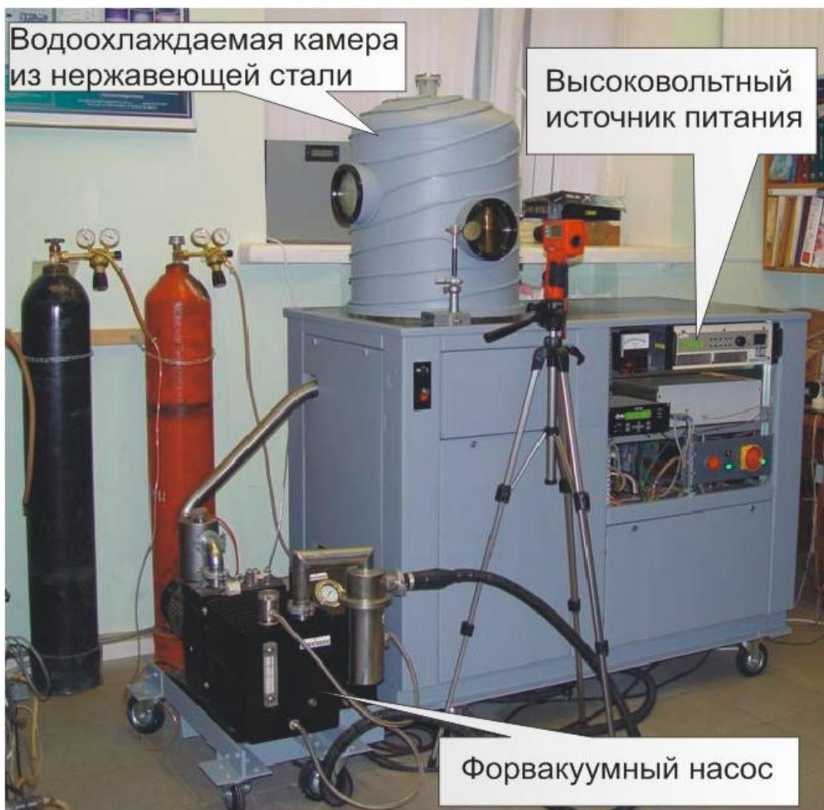
*Рис. 2.1. Изображение экспериментальной плазмохимической установки для осаждения углеродных пленок*
