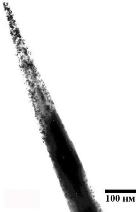
Рисунок 3.5. Светлопольное изображение образца (иглы) литого высокоэнтروпийного сплава AlCrFeCoNiCu для исследования на томографическом атомном зонде [60].
