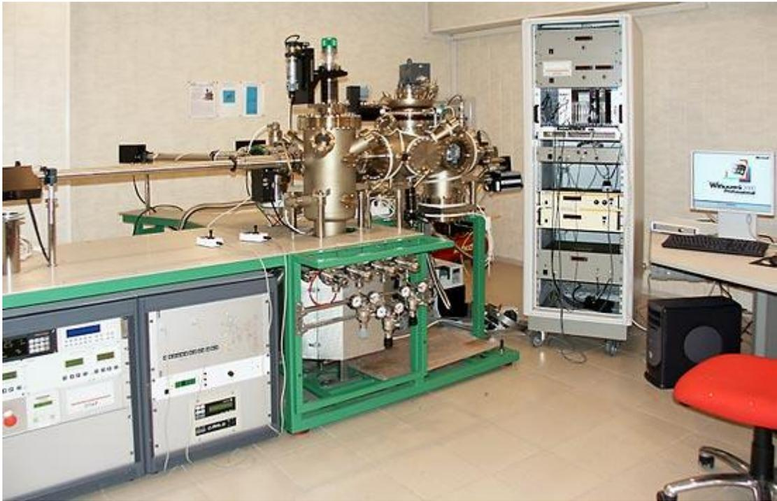
Рисунок 2.4. Общий вид Оптического томографического атомного зонда Cameca atom probe (3D-AP).
