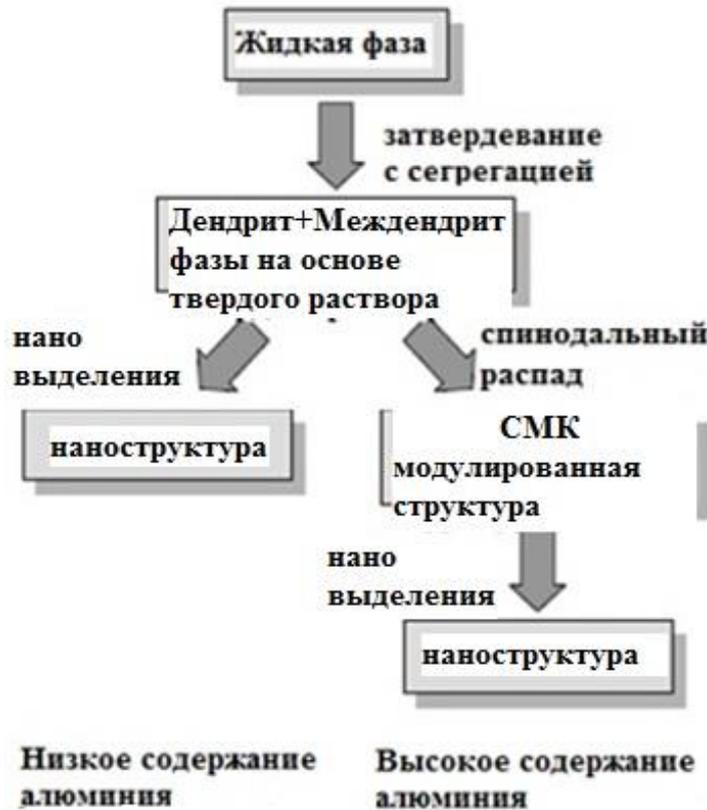
Рисунок 1.14. Схема последовательности фазообразования во время охлаждения  $Al_xCoCrCuFeNi$  сплавов с различным содержанием алюминия [35].
