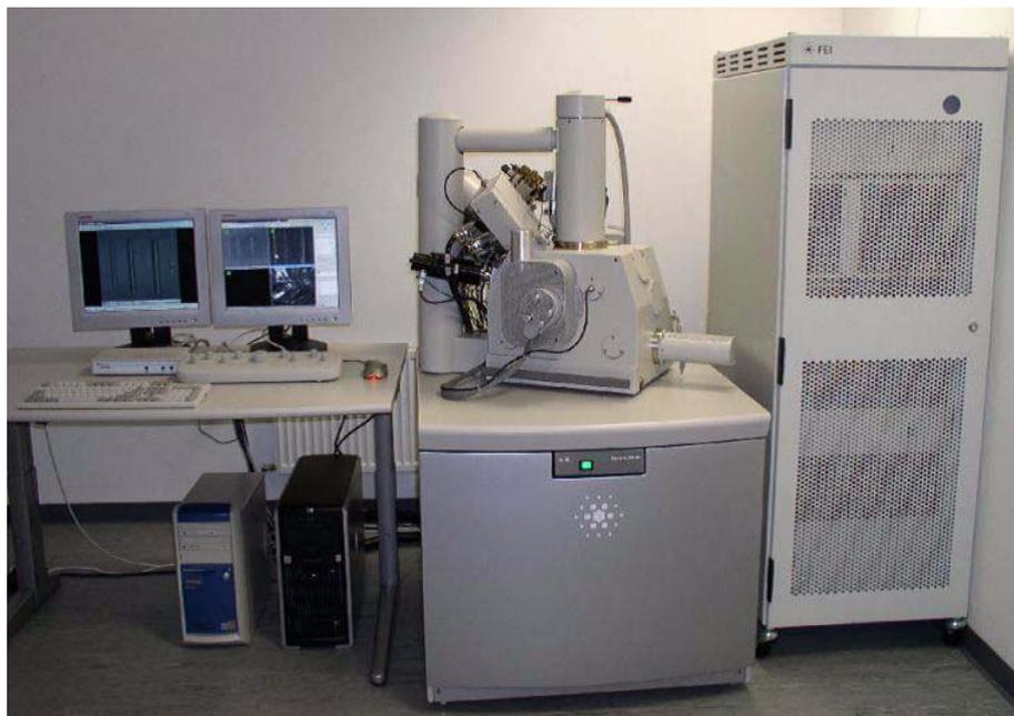
Рисунок 2.1. Общий вид сканирующего электронного микроскопа Quanta 200 Pegasus.
