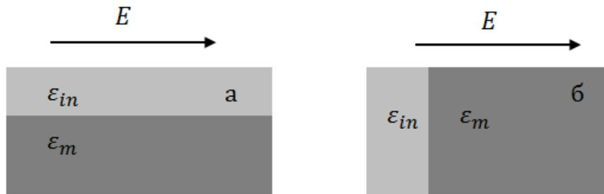
Рисунок 4.2 – Параллельная (а) и последовательная (б) конфигурации композита
