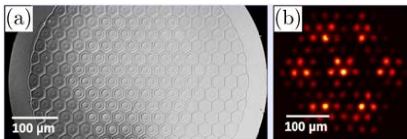
Рис. 1.21. (a) Фотография массива, использовавшегося в эксперименте. (b) Выходное распределение интенсивности в массиве длиной 50 mm в линейном режиме.
