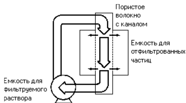
Рис.2.1. Схема установки для фильтрации продуктов синтеза методом перекрестного потока.
