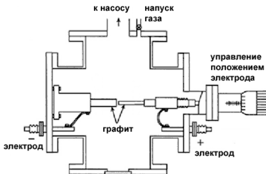
Рис.1.7. Схема установки для синтеза нанотрубок в дуговом разряде (из работы [17]).
