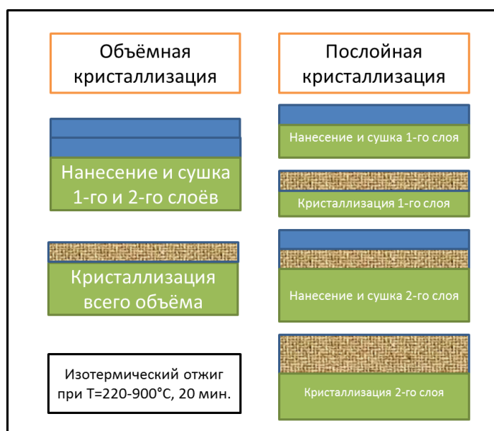
Рис.15. Схема формирования структуры сегнетоэлектрических плёнок: способы нанесения, кристаллизации и термообработки
