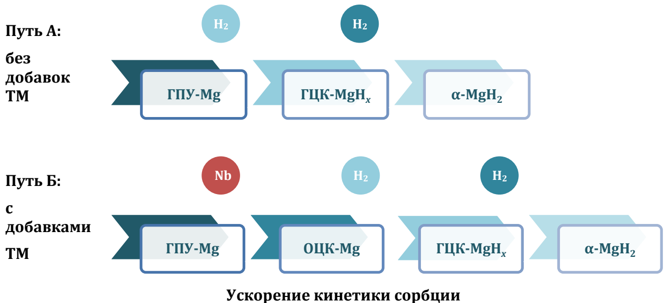
Рис.4.13. Схема фазовых превращений происходящих в процессе гидрирования магния
