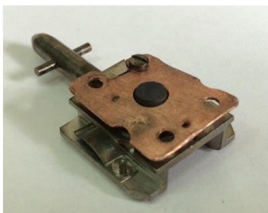
Рисункок 2.4 – Катод из искусственных углеродных материалов в держателе.
