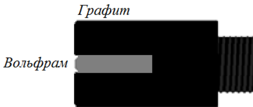
Рисунок 3.3 – Схематическое изображение вольфрамографитового анода.
