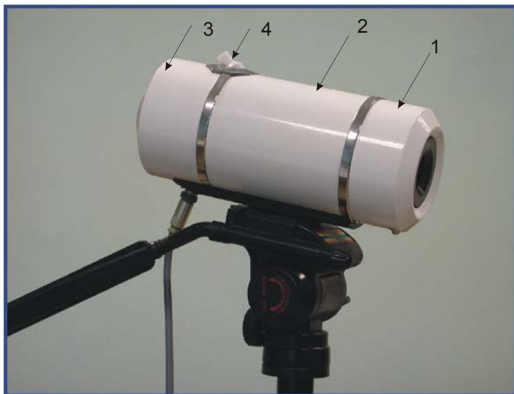
Рис.8.29. Общий вид тепловизионной камеры. Здесь 1 – отсек объектива и узла калибровки, 2 – отсек криостата, 3 – отсек электроники, 4 – горловина для заливки жидкого азота.
