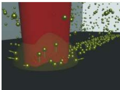
Рисунок 4.1 – Принципиальная схема эксперимента по лазерному осаждению металлических наночастиц из коллоидной системы: 1 – лазерное излучение, 2 – кювета с коллоидным раствором, 3 – подложка, 4 – трек осаждения наноструктурированной поверхности.
