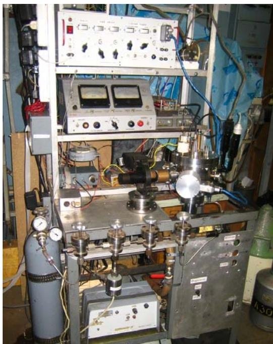
Рисунок 21. Нанолюминограф. Внешний вид.
