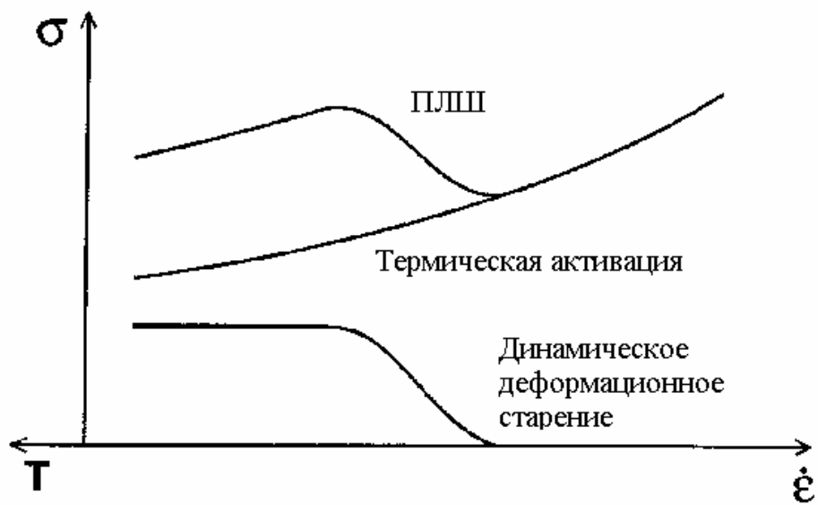
Рис. 1.3. Схематическое изображение конкуренции термической активации и пиннинга дислокаций атомами примеси, приводящей к нелинейной N-образной форме скоростной чувствительности напряжения.
