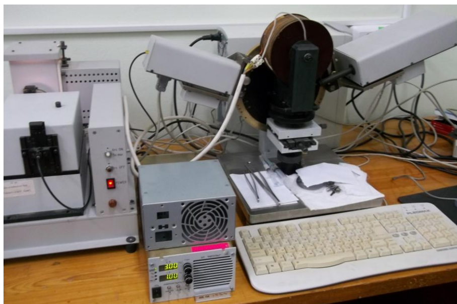
Рисунок 12 – Внешний вид ex situ спектрального эллипсометра Эллипс-1891 с электромагнитом для магнитоэллипсометрических измерений
