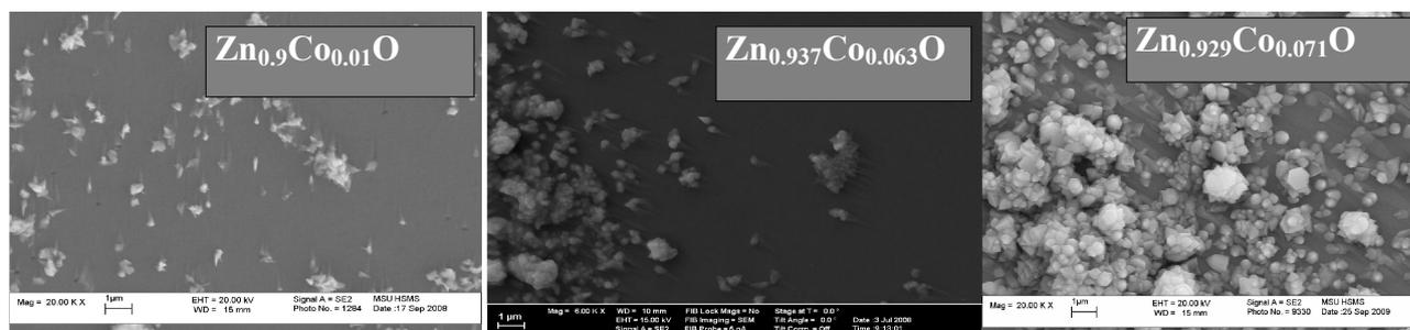
Рисунок 2.14 Изображения поверхности пленок ZnO:Co с различным содержанием кобальта, полученные методом СЭМ
