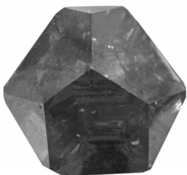
Рис. 5.8. Соотношение гранных и округлых форм на фронте в зависимости от скорости кристаллизации: а - скорость кристаллизации 2.5 мм/ч; б – скорость кристаллизации 0.2 мм/ч; в – скорость кристаллизации 0.05 мм/ч
