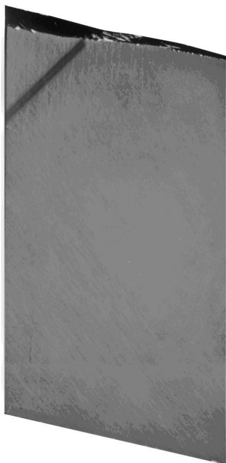
Рис. 5.6. Рентгеновская топограмма кристалла BGO, темная полоса на топограмме – дефект фотоэмульсии.
