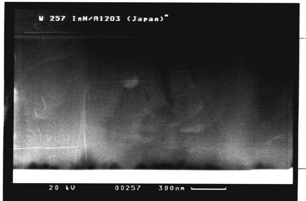
Рис.2.9. СЭМ фотография скола InN, выращенного на низкотемпературном ( \sim 350^{\circ}\text{C} ) буфере InN на сапфировой подложке.
