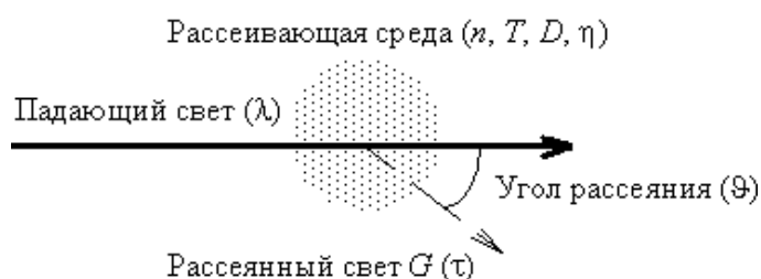
Рис. 11. Схема метода корреляционной спектроскопии рассеянного света.
