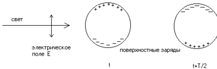
Рис. 1. Возбуждение дипольного поверхностного плазмона электрическим полем падающей волны с периодом T [44].
