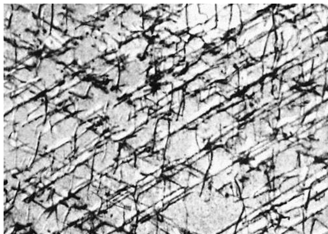
Рис. 1.10. Топограмма монокристалла кремния, полученная по методу Бормана. Толщина кристалла 0.3 мм. Видны отдельные ростовые дислокации (тёмные линии).
