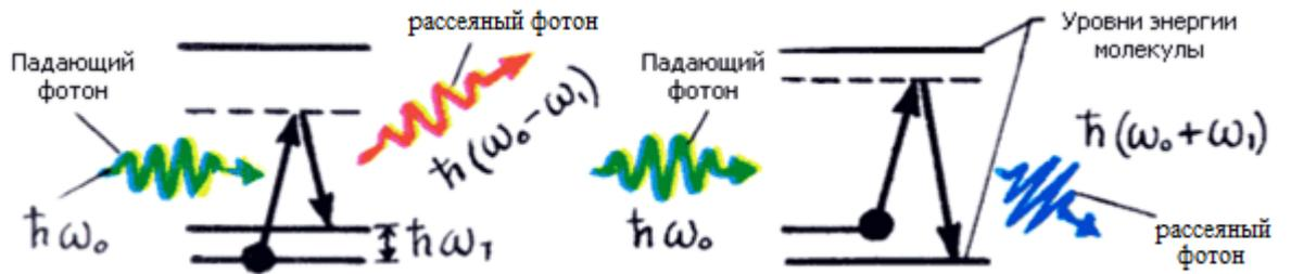
Рис. 2.7. Квантовая картина комбинационного рассеяния света.
